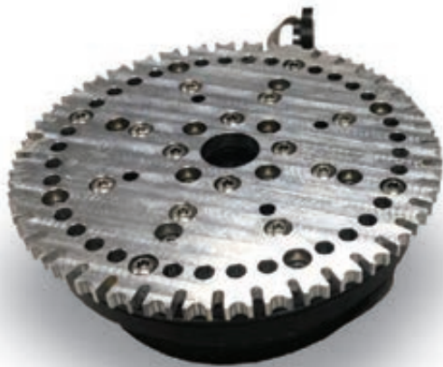
Das Revolvermagazin mit mehreren Kammern, in denen die biologischen Proben untergebracht sind.
