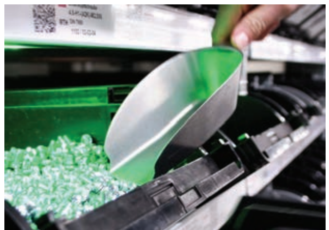
Durch Scannen eines QR-Codes am Sichtlagerkasten führt das hausinterne Assistenzsystem »iCParts« Mitarbeiter per Leuchtsignal zum gesuchten Artikel.
