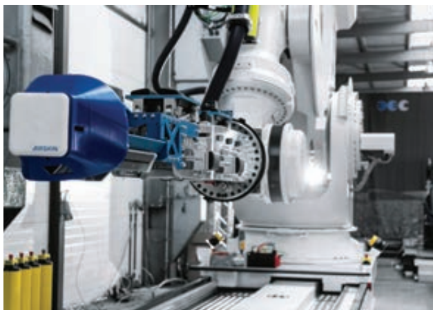
Das High-Tech-Greifsystem am Knickarmroboter: Wenn der Greifer die Spulen aufnimmt und in den Magneten einsetzt, dürfen sich diese auf keinen Fall verdrehen oder verrutschen.
